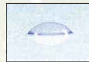
水接触角50° (従来の低汚染塗料)
